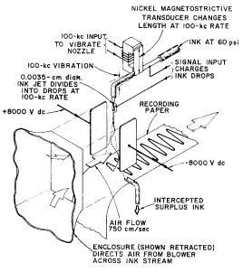
Fig. 1. Ink-jet oscillograph.
